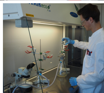
Abbildung 32 Arbeitsplatz mit Single Particle Explorer (SPE); Filtration in Reinstwerkbank
